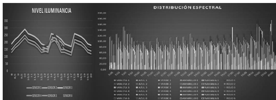
Figura 4. Representación gráfica del nivel de iluminancia y distribución espectral en 6 franjas para el caso de 6 sensores, con muestras cada 30 minutos durante 12 horas
