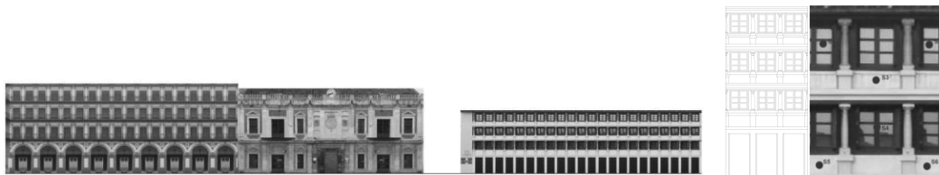
Figura 3. Alzado Sur de la Plaza de la Corredera, con el Mercado en el centro y el edificio CEUX a la derecha, y módulo fachada edificio CEUX y ubicación de sensores en las dos últimas plantas.
